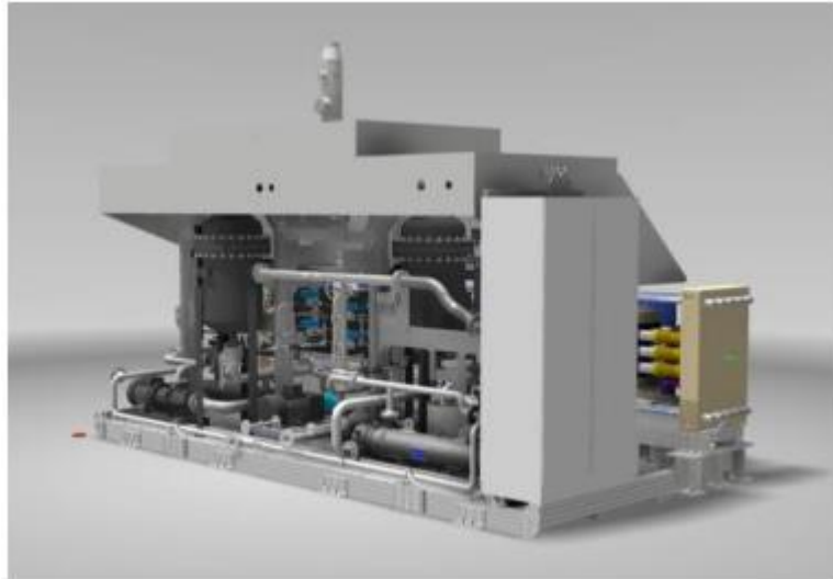
Figura 2. Representación del electrolizador PEM de Siemens (HIF Spa, 2020)
