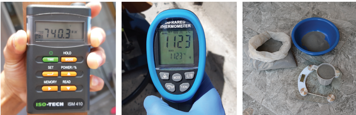
Fig. 98-100. Medición de irradiancia solar, temperatura en punto focal y densidad de relave. Elaboración propia.
