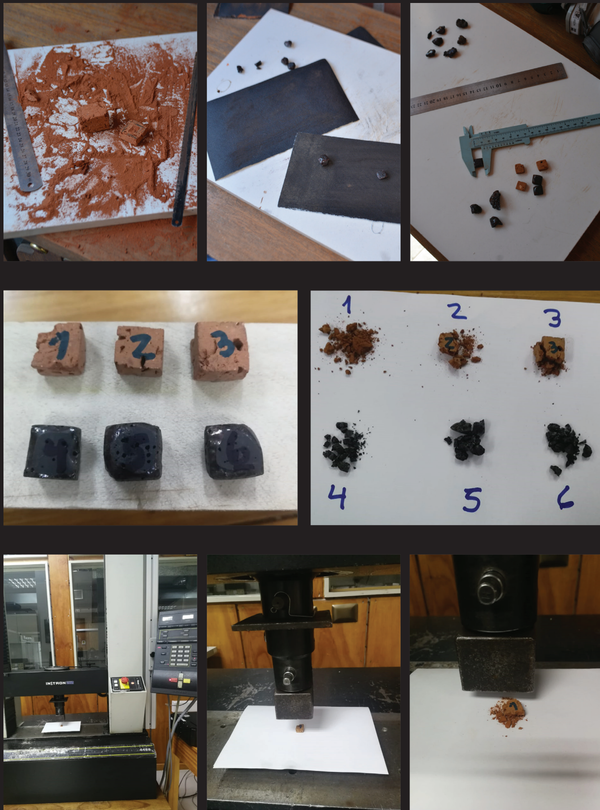
Fig. 125-132. Ensayo de compresión: lijado, dimensionado, numerado, comprimido con prensa Instron. Fuente: Elab. propia y C. Droguett..
