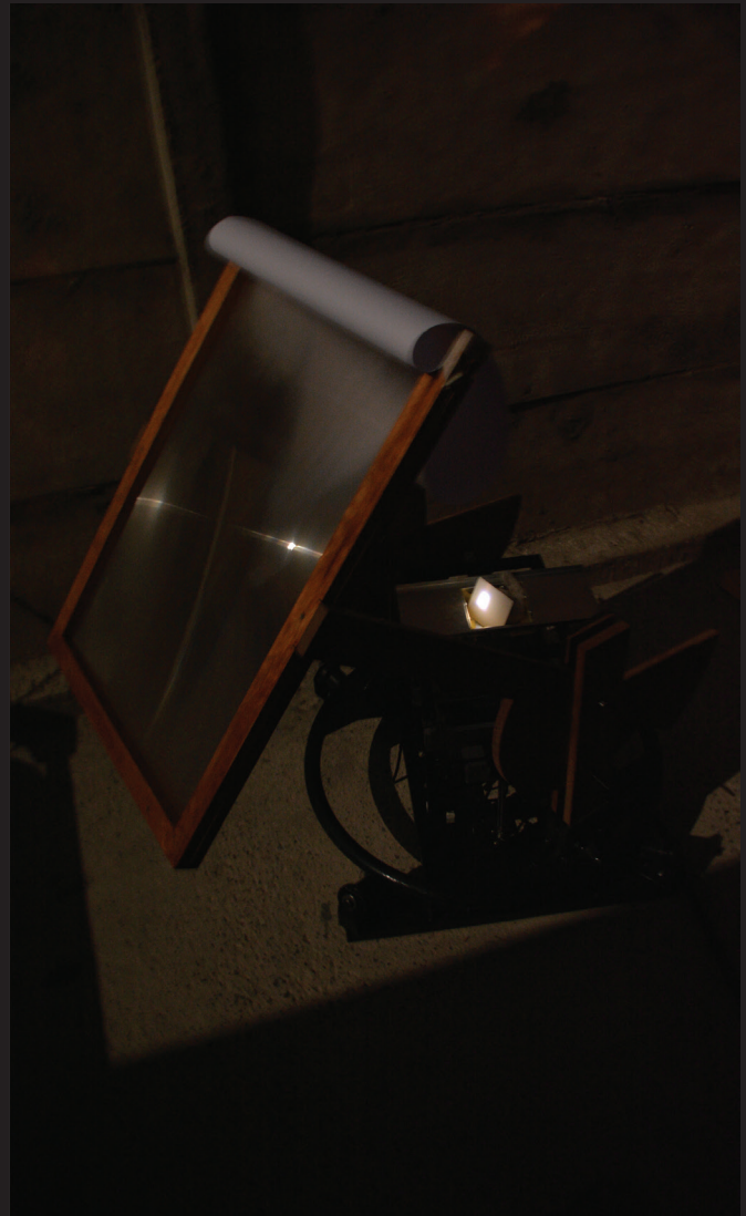
Fig. 95-97. Medición de la distancia y diámetro focal aprovechando luz paralela de la Luna. Elaboración propia.
