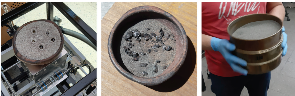
Fig. 101-102. Pruebas preliminares en arena de playa y en relave, demostraron necesidad de tamizaje. Elaboración propia.
