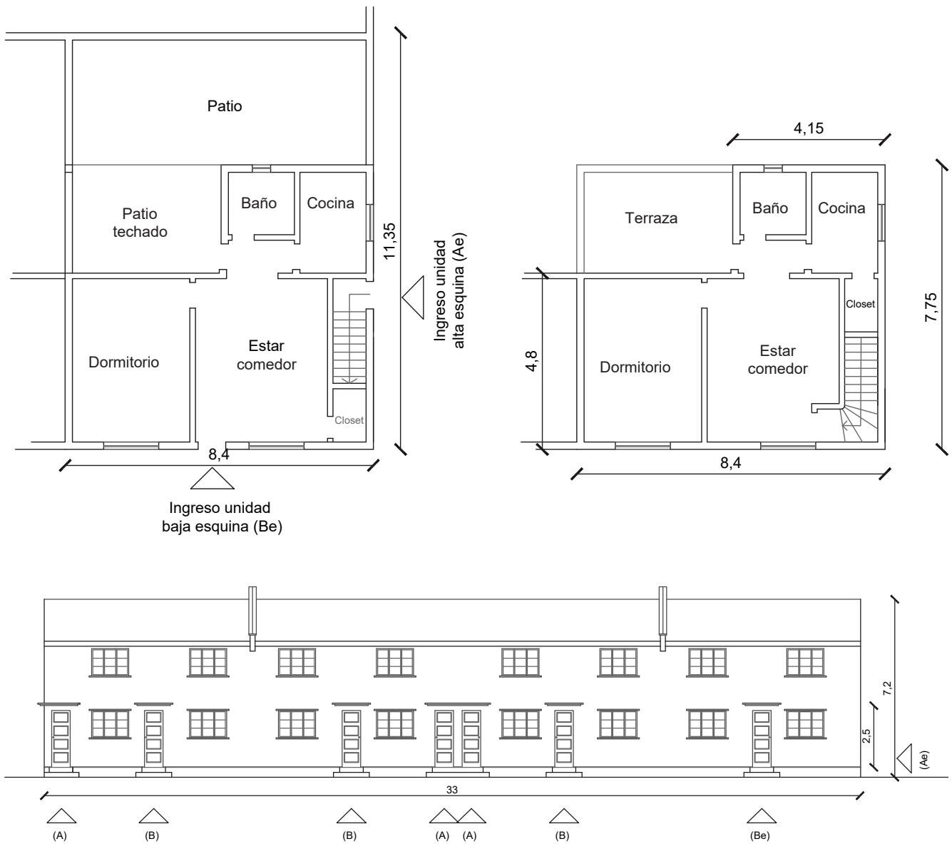
Plano 5: Planos vivienda esquina tipo, bloque Población Gratty Fuente: Elaboración propia en base a archivos DOM
