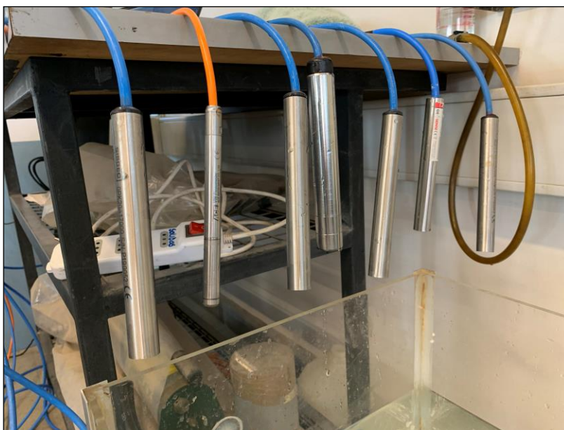
Figura 23: Ensayo de consideración de presión atmosférica. Sin filtro. Condición no saturada.
