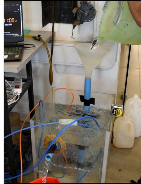
Figura 31: Ensayo de verificación de mediciones con flujo en el sistema sin suelo. Filtros LAE. Condición saturada.
