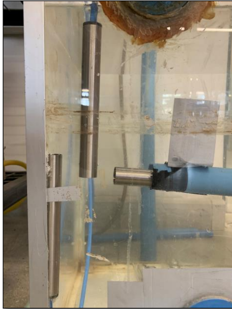
Figura 27: Ensayo de verificación de mediciones con inclinación del piezómetro en presencia de agua (sin suelo). Sin filtro. Condición saturada.
