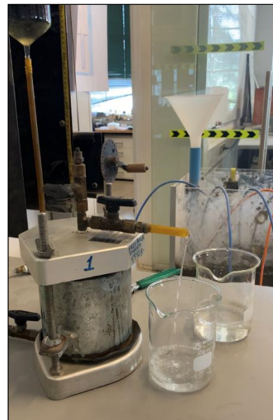
Figura 22: Ensayo de permeabilidad de carga constante - Ejecución.
