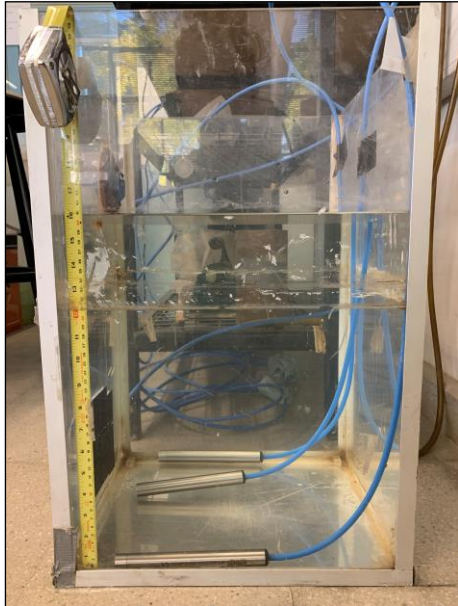
Figura 25: Ensayo de verificación de mediciones con distintas condiciones de saturación de los filtros. Filtros HAE. Condición saturada.
