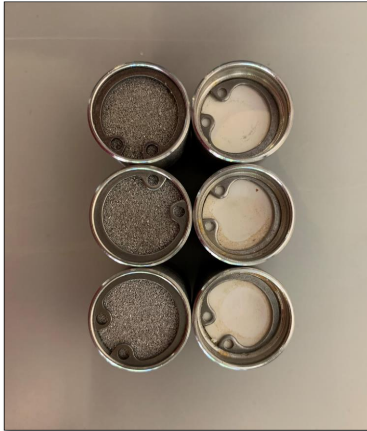
Figura 6: Filtros de piezómetros de cuerda vibrante, LAE (gris oscuro) y HAE (blanco).
