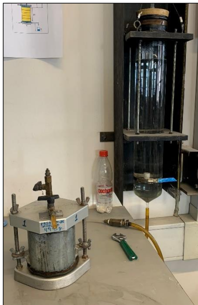
Figura 21: Ensayo de permeabilidad de carga constante - Preparación. A la derecha se puede apreciar el permeámetro de carga constante.
