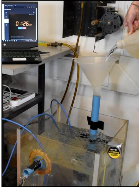
Figura 30: Ensayo de verificación de mediciones con flujo en el sistema sin suelo. Filtros HAE. Condición saturada.
