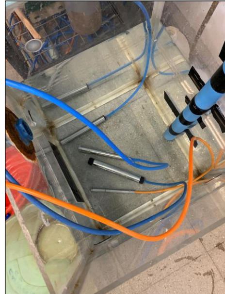
Figura 26: Ensayo de verificación de mediciones con distintas condiciones de saturación de los filtros. Filtros LAE. Condición no saturada.
