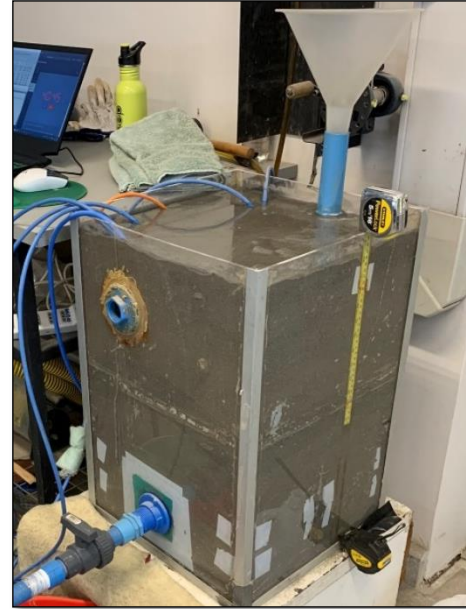
Figura 35: Ensayo de verificación de mediciones con suelos de diferente permeabilidad. Arena de relaves (SP-SM) de menor permeabilidad. Condición saturada.
