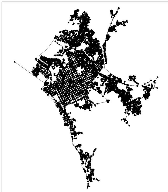
Figura 5.35: Red de distribución de agua potable en EPANET.
