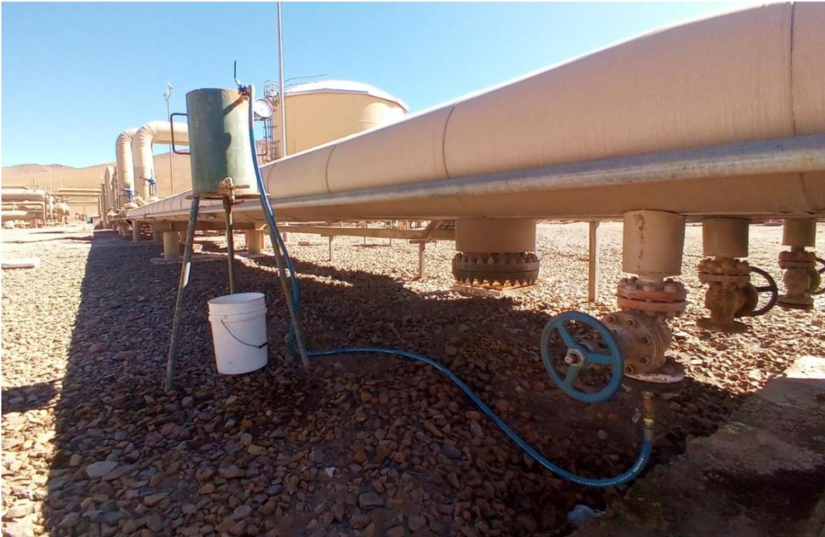
Figura 30: Montaje de condensador para muestreo químico de salmueras y vapor. Fotografía propia.
