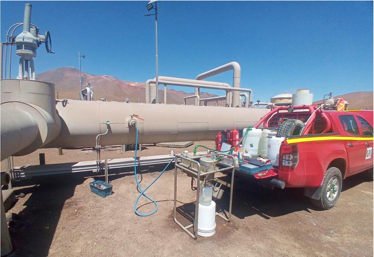
Figura 31: Montaje de muestreo para gases no condensables y medición razón gas/vapor. Fotografía propia.
