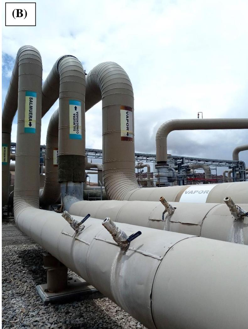
Figura 26: A) Cuponera atornillada al portacupón lista para inserción en tubería. B) Puntos de inserción de portacupones en líneas de salmuera de producción y reinyección (“condensada” en la foto).
