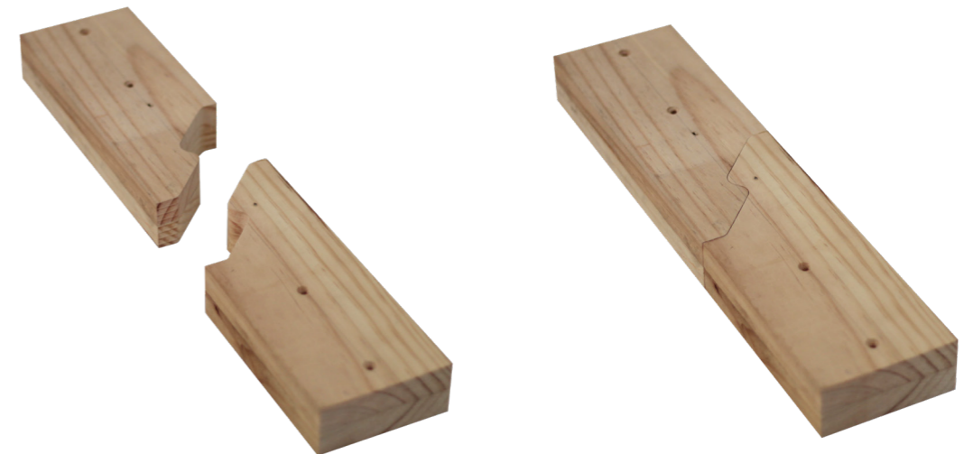
Fig. 16: Empalme rayo de júpiter, variante en pino radiata y elaborada con una Router CNC. Fuente: Elaboración propia.
