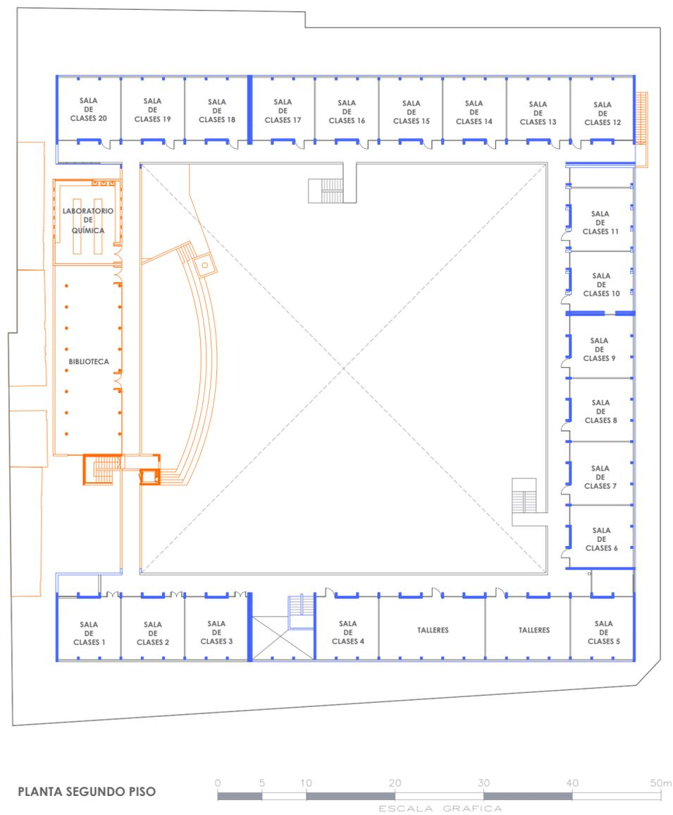
Fig. 9: Planta segundo piso con preexistencias que se conservan y las que se eliminan. Fuente: Elaboración propia
