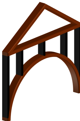
Figura 3.6 Esquema de bóveda con sistema en viga
