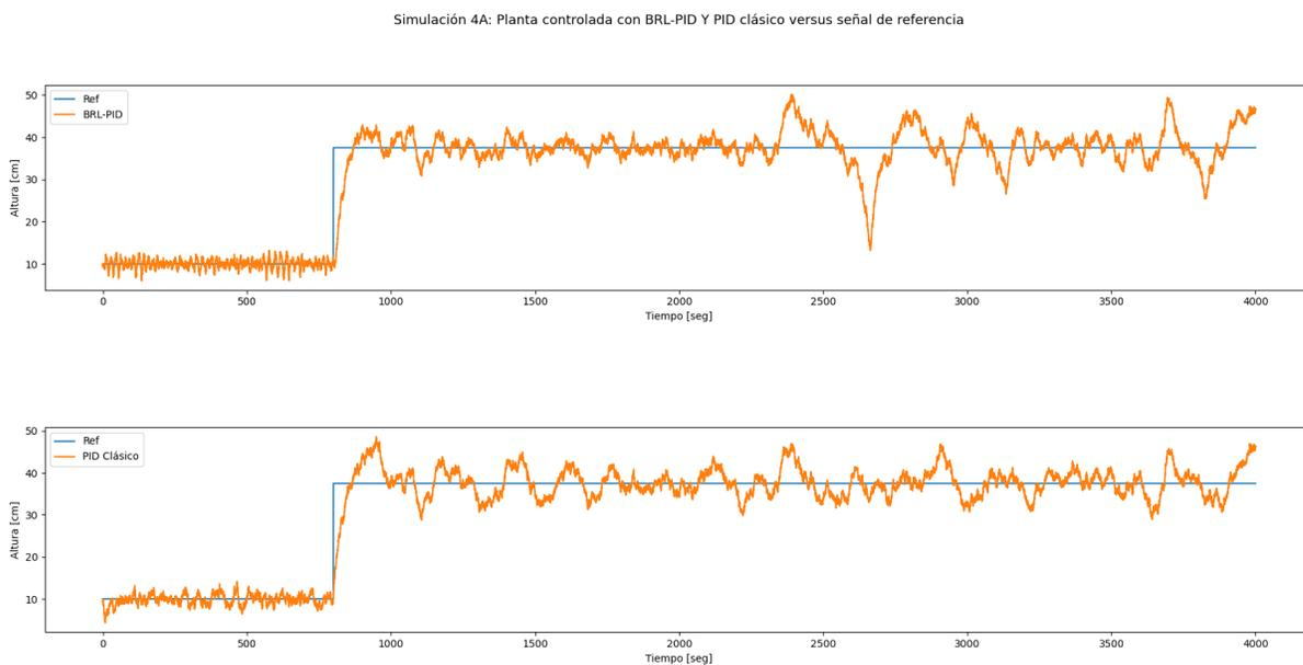
Figura 5.14: Simulación 4A: Respuesta de la planta ante una referencia de escalón controlada por el BRL-PID (arriba) y el PID clásico (abajo). Referencia sucesión de escalones, sin ruidos en la planta y sin valores en la memoria al inicio de la simulación.
