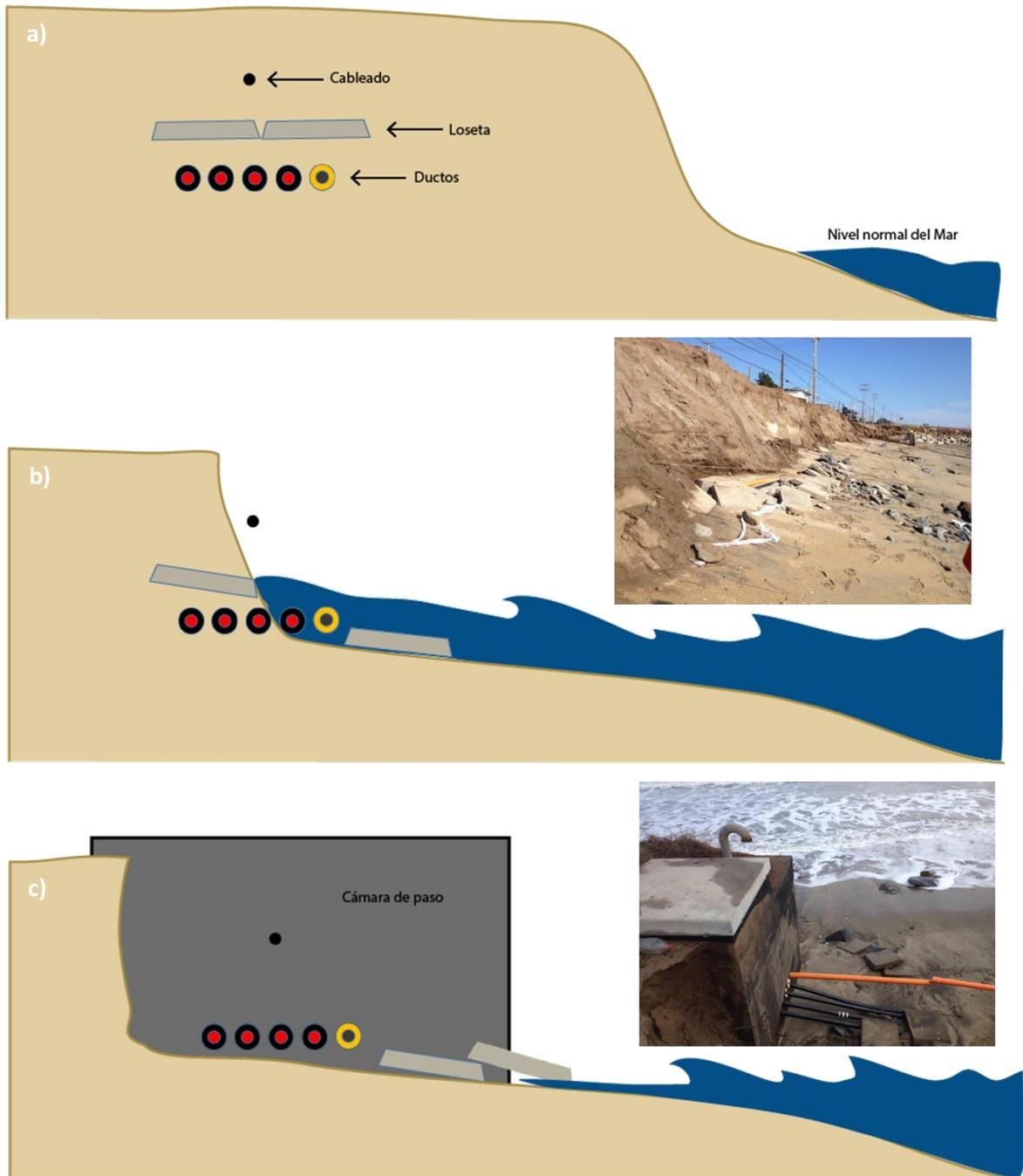
**Figura N° 40:** Erosión de terraplén junto a la parte posterior de la playa, y daños a línea de transmisión eléctrica subterránea expuestas por oleaje (frente a OXIQUM, en unidad de evaluación Industrial 10). a) Representación estado de terraplén previo al temporal del 8 de agosto de 2015. b) Erosión de terraplén y daños en líneas de transmisión eléctrica subterránea. c) Exposición de cámara de paso de línea de transmisión eléctrica por erosión de terraplén. **Fuente:** Elaboración propia.
