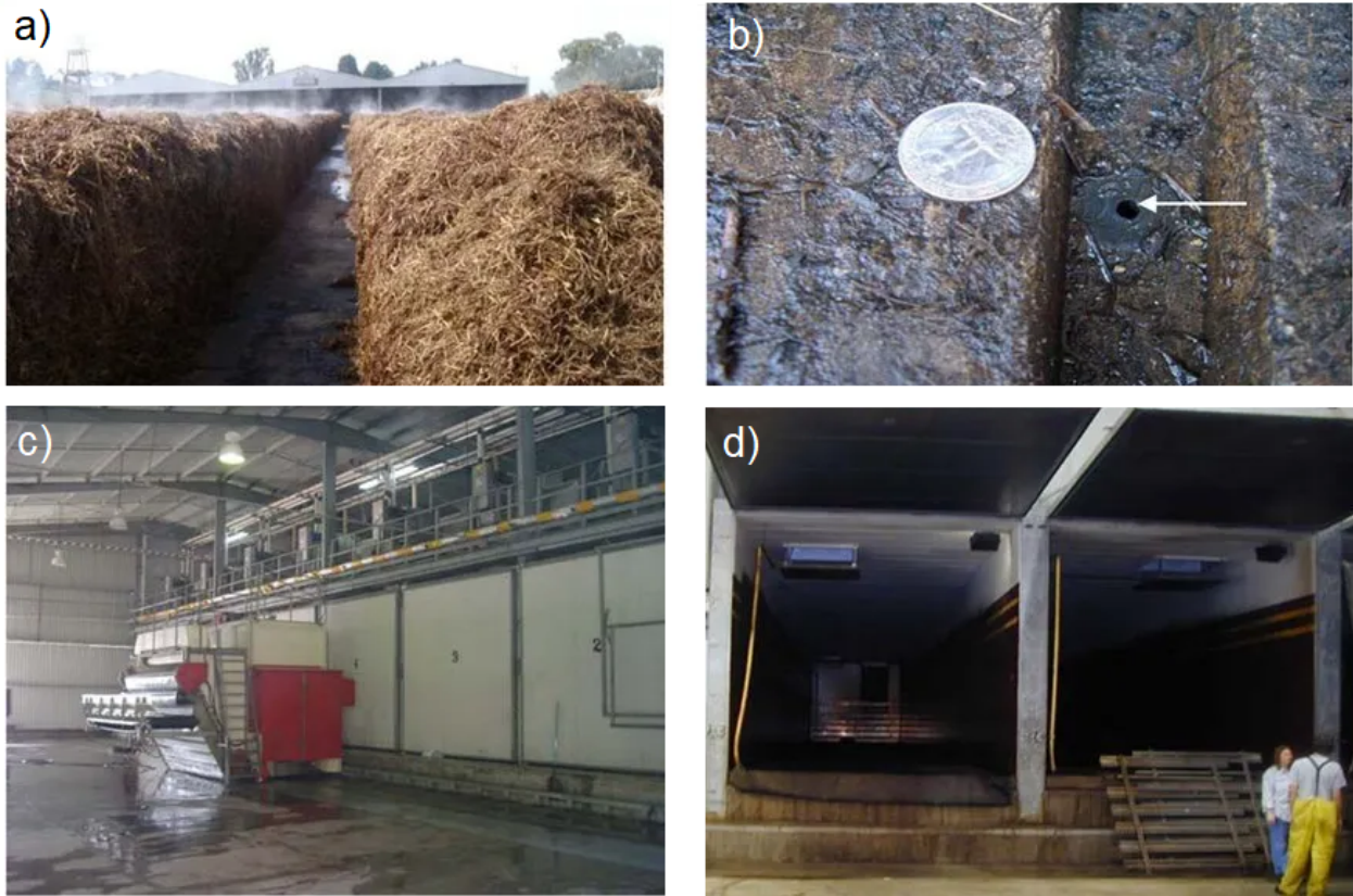
Figura 4.12: a) Pilas de sustrato en el proceso de fermentación libre, b) canales de aireación, c) Exterior de una pieza de esterilización y máquina de llenado, d) pieza de esterilización tipo túnel. Nota. Extraída de [86].
