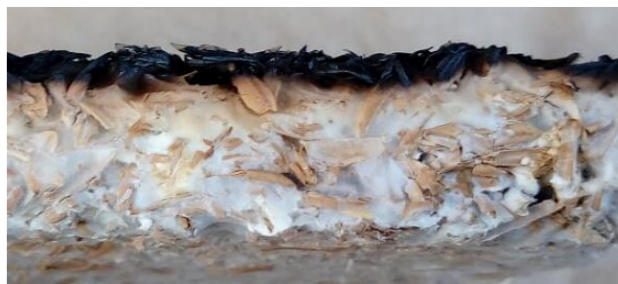
Figura 2.7: Formación de ceniza sobre MMC al exponerse al fuego [53].
