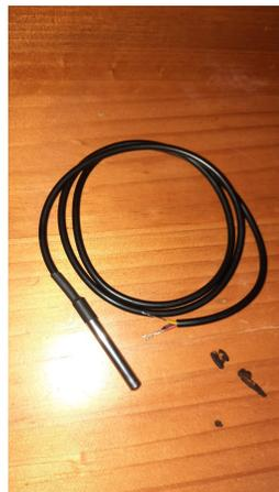
(a) Imagen del sensor utilizado para medir temperatura de suelo.
