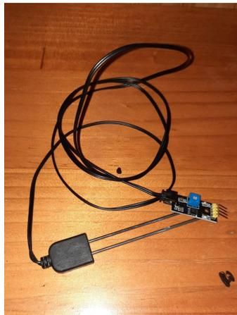
(b) Imagen del sensor utilizado para medir humedad de suelo.
