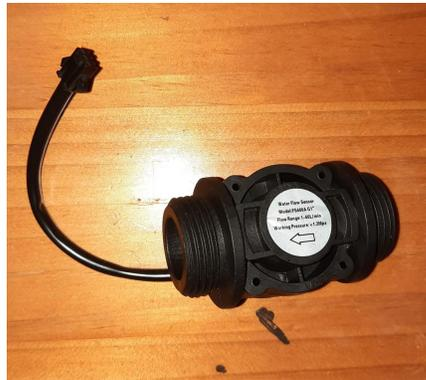
(a) Imagen del sensor de flujo de agua DN25.
