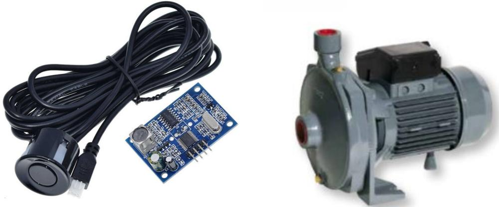
(a) Imagen del sensor de nivel AJ-SR04.      (b) Imagen de bomba centrífuga de agua.
