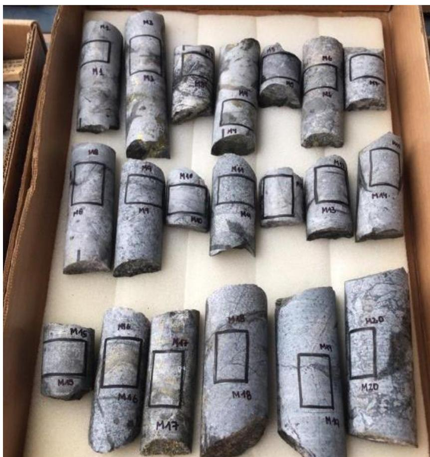
Figura 3.5: Muestras seleccionadas: Ordenadas hacia la derecha. En el re- cuadro se observa la zona donde se le hará el corte (En ANEXO A se puede ver en mayor detalle).
