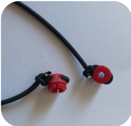
Figura 87: Conector tensores con elástico. (Elaboración propia)
