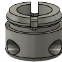
Figura 84: Modelo 3D Conector tensores (Elaboración propia)
