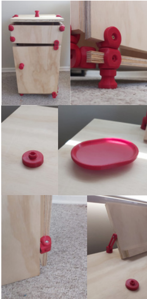
Figura 104: Armado mobiliario. (Elaboración propia)
