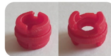
Figura 57: Prototipos "snap fit" funcionales (Elaboración propia)
