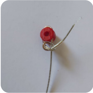
Figura 86: Conector tensores con cable de acero. (Elaboración propia)
