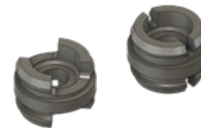
Figura 56: Modelo 3D "snap fit" funcionales (Elaboración propia)
