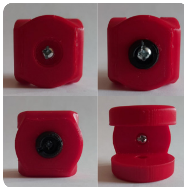
Figura 66: Uso de tornillos en pieza principal. (Elaboración propia)
