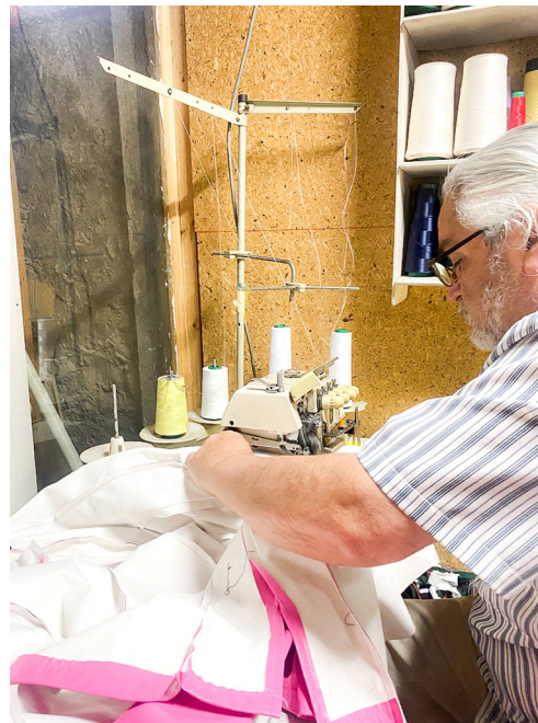
Figura 74: Utilización de máquina overlock en terminaciones de costura. Elaboración propia.
