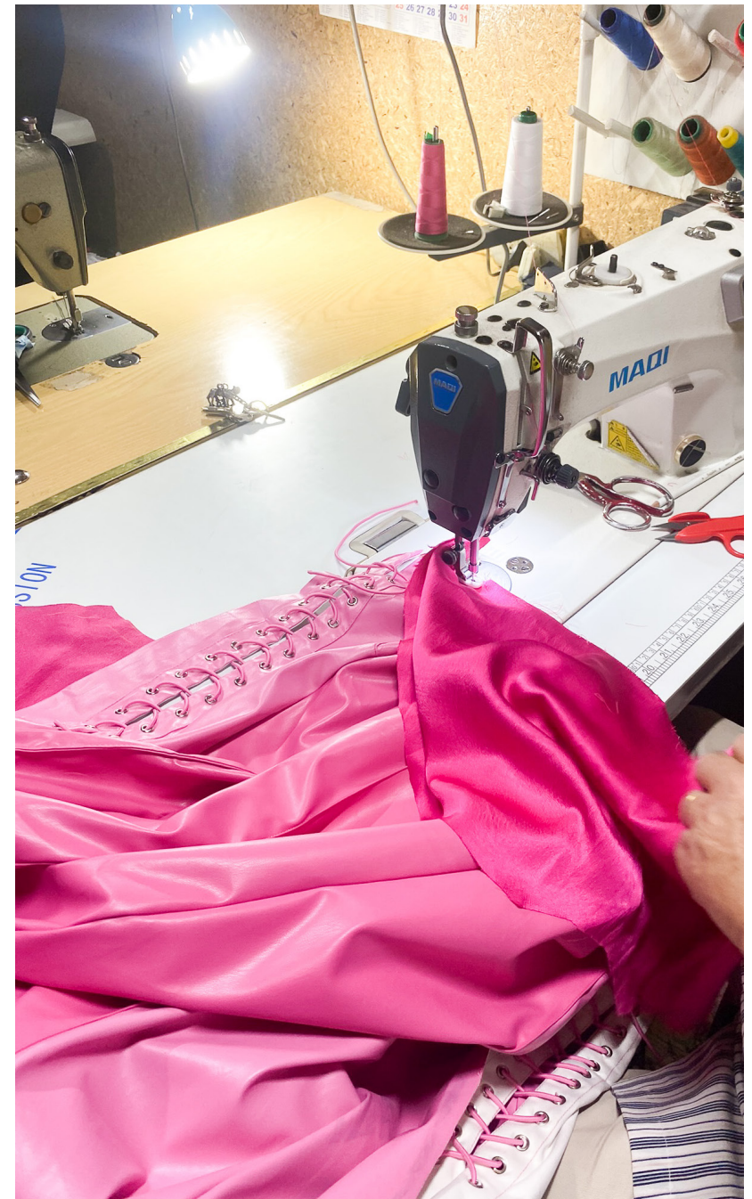
Figura 70: Construcción espalda de la capa, unión de canesú y tablón trasero. Elaboración propia.
