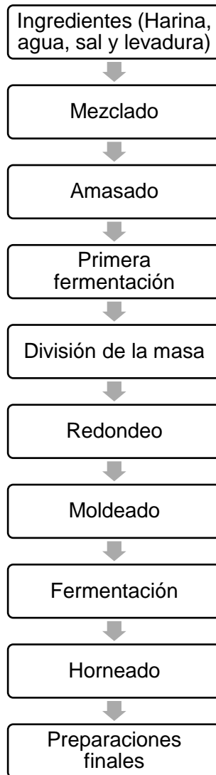
Figura 2.1 Etapas del proceso de panificación.
