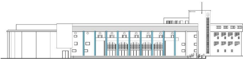
FACHADA ORIENTE Figura 64 y 65. Fachada Oriente, marcos rígidos.
