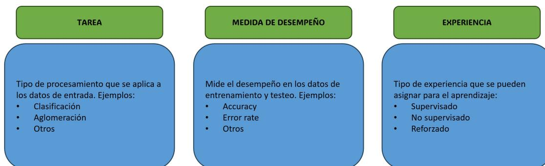
Figura 2.9: Esquema resumen para los tipos de tarea, métricas y experiencias en aprendizaje mediante algoritmo de *machine learning*.
