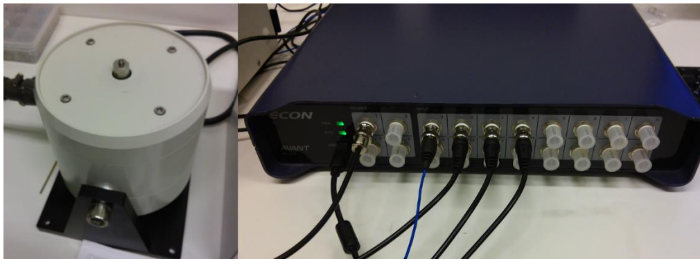
Figura 28. a) Agitador electrodinámico. b) Hardware de adquisición de datos
