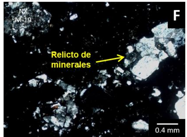
Figura 36: Cortes delgados de las muestras a nicols paralelos (NP) y nicols cruzados (NX): PE-10 (A y B), PE-12 (C y D) y M-19 (E y F). En ellas se puede apreciar parte de la roca que aún conserva sus minerales sin silicificar (A y B), tobas altamente silicificadas, con formación de calcedonia (C y D), y rocas que sólo conservan relictos de sus minerales originales (E y F).
