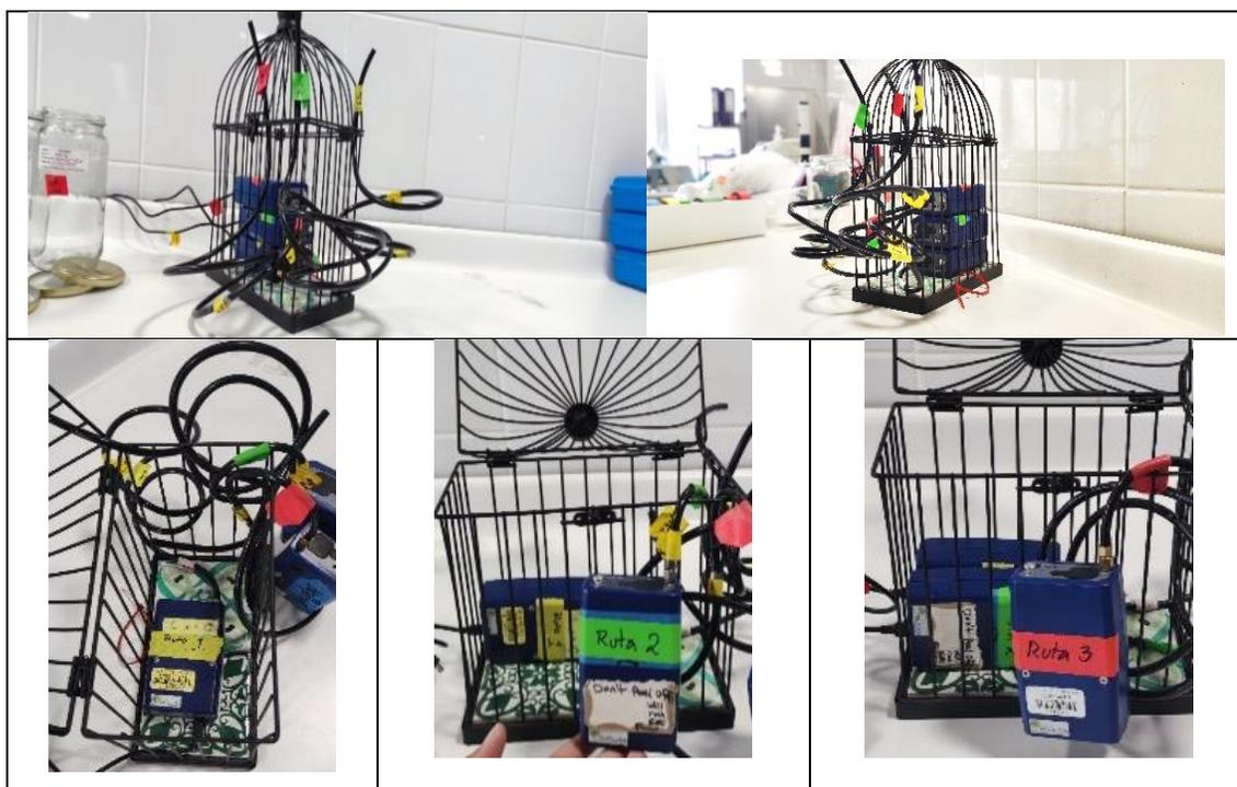
**Set fotográfico 1.** Proceso de intercomparación de microetómetros AE51 en laboratorio.
