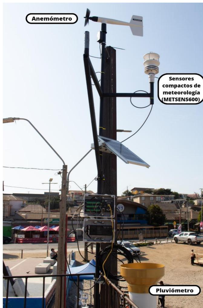
**Figura 8.** Instalación estación meteorológica: "Estación Experimental"
