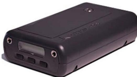
**Figura 3.** Microetalómetro microAeth MA200. (Aethlabs, 2018).
