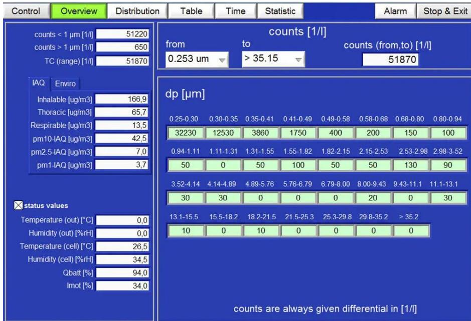
Figura. E. Software GRIMM-Spectrometer
