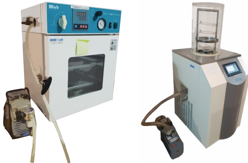
Figura 8. Equipos de secado: Estufa de vacío Mlab MVO-024 (8a) y liofilizador SUMTRON CTFD-18P (8b)
