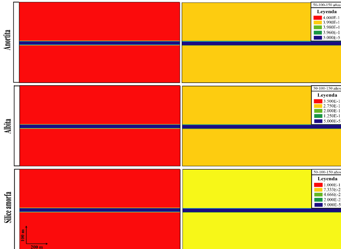
Figura 19. Distribución espacial de la fracción volumétrica ( m^3 mineral/ m^3 medio poroso) de los minerales silicatados a lo largo de 150 años de simulación en el medio fracturado.
