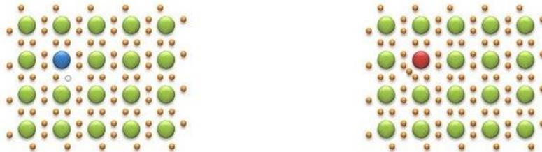
**Figura 3: Semiconductores extrínseco, muestra tipo p(izquierda), de tipo n(derecha).**
