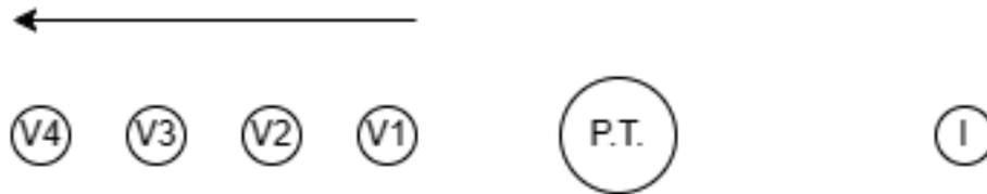
Figura A.2: Movimiento del electrodo de potencial para el método variado de medición.
