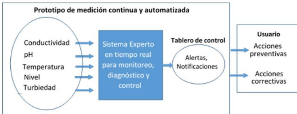
Figura 1-1: Entradas y salidas del sistema experto. Fuente: Formulación del proyecto Fondef ID19I10363 (2019)
