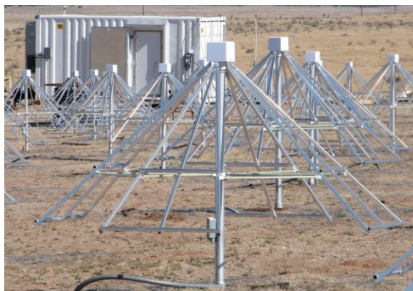
Figura 2.3: Fotografía de una “base” de antena activa de LWA. Consiste de dos antenas dipolo tipo bowtie alineadas ortogonalmente en un mástil, sobre una pantalla de tierra metálico de 3 \times 3 m [29].
