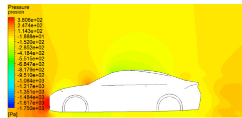
(f) Detalle de presión a 100 [km/h]
