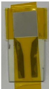
Ilustración E-1: Aplicación de cinta kapton a sustrato para depositar material mediante técnica de drop casting.
