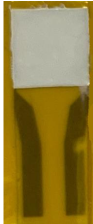
Ilustración E-2: Muestra depositada con kapton alrededor.
