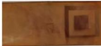
Ilustración 79: Fotoresina adherida al sustrato en el proceso de revelado.
