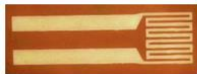
Ilustración 87: Prueba de exposición con dosis de 150 [ \text{mJ}/\text{cm}^2 ].
