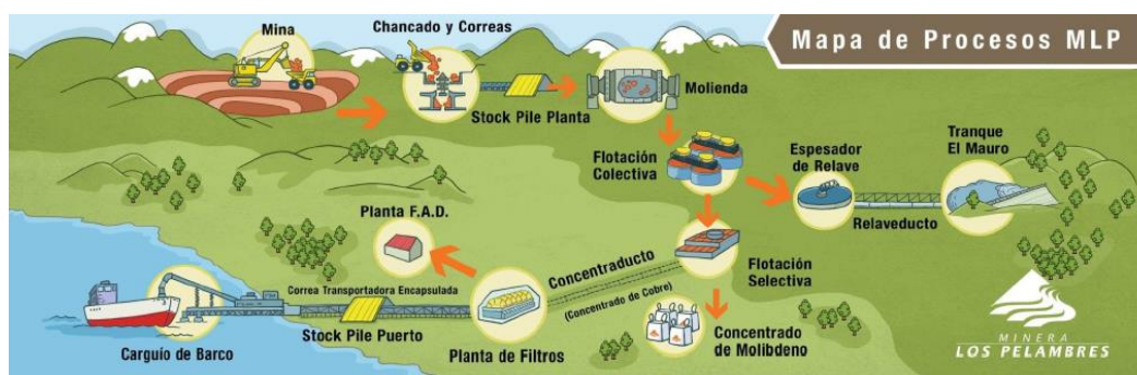
(Figura 5: Mapa de procesos para la producción de cobre, Fuente: web.pelambres.cl).
