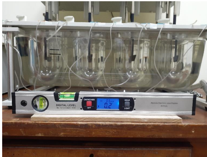
Figura A2. Nivel digital sobre mesa en donde se poya el equipo disolutor. Lectura de 0,2^\circ de desnivel.
