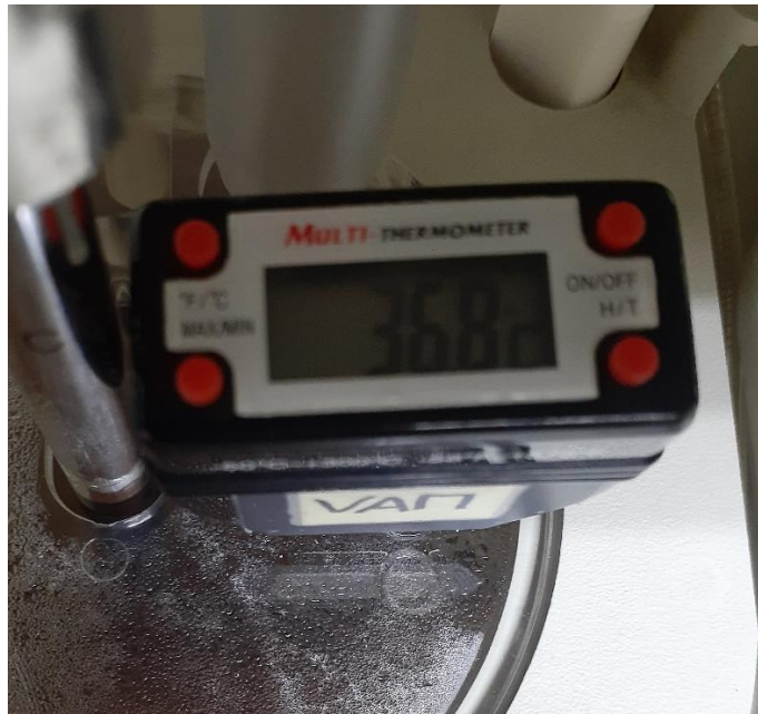
Figura A7. Termómetro digital en vaso de equipo disolutor. Lectura de 36,8 °C.
