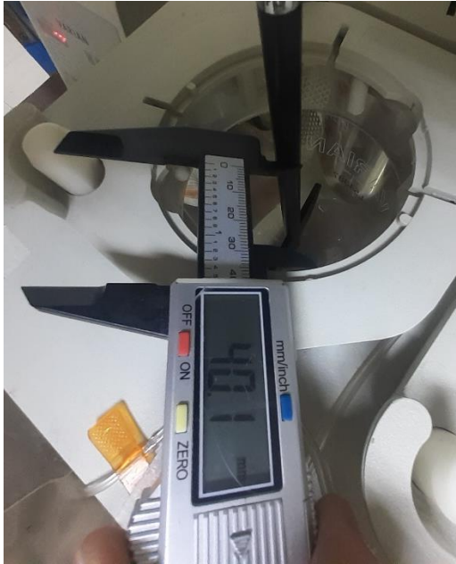
Figura A5. Distancia entre eje de paleta y vaso de equipo disolutor. Lectura de 40,1 mm.
