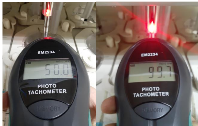
Figura A6. Tacómetro sobre eje de paleta de equipo disolutor. Lectura de 50,0 rpm y 99,7 rpm.
