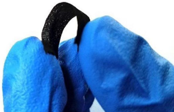
Figura 18. Fotografía del sensor de glucosa flexible 73 .
