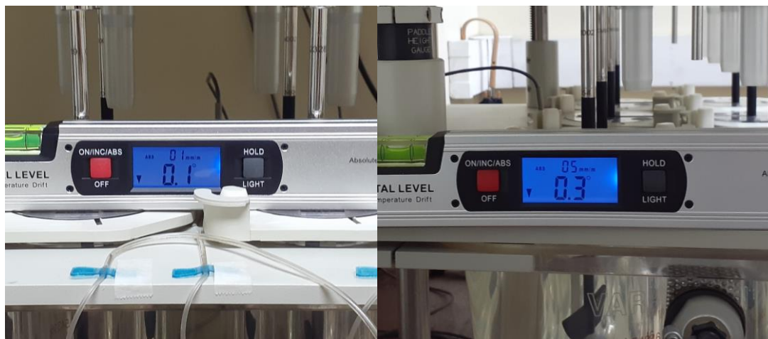
Figura A3. Nivel digital en la base de los vasos de equipo disolutor. A lo ancho con una lectura de 0,1^\circ de desnivel (izquierda), y a lo largo de 0,3^\circ (derecha).
