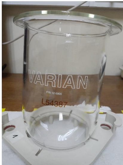
Figura A1. Vaso equipo disolutor limpio y sin rayones. Capacidad 1 L.
