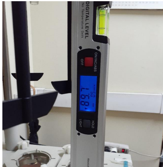
Figura A4. Nivel digital sobre eje de paleta de equipo disolutor. Lectura de 89,7^\circ de verticalidad.
