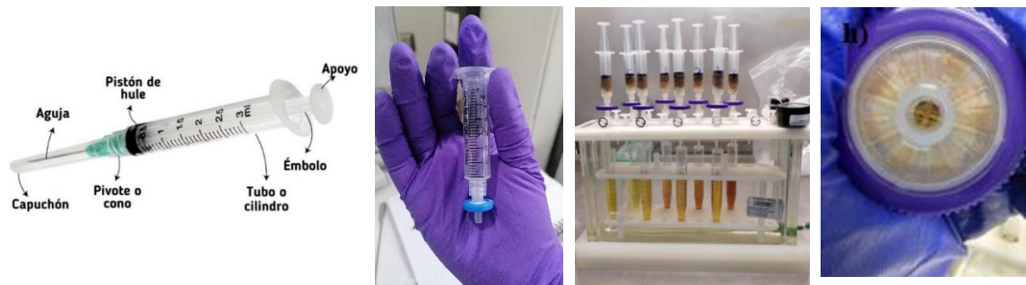
Figura 20 Se observa la estructura de una jeringa típica, se muestra la estructura luego de cambiar la aguja por un filtro PVDF, y el colapso del filtro producto de los componentes de la premezcla que impiden la correcta elución hacia el sistema colector.
