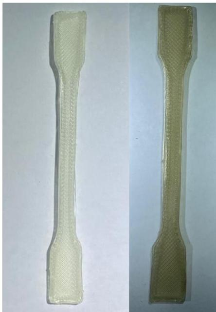
**Figura 32.** Fotografías de probeta de PVA (izquierda) y mezcla de biopoliéster de PA con PVA (derecha).
