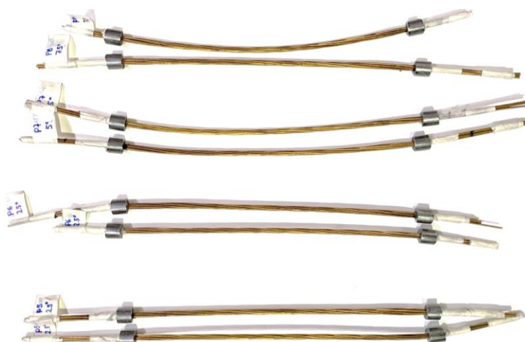
Figura 5-13. Cables de 1x7 de SMA de CuAlBe para ensayo del SECB
