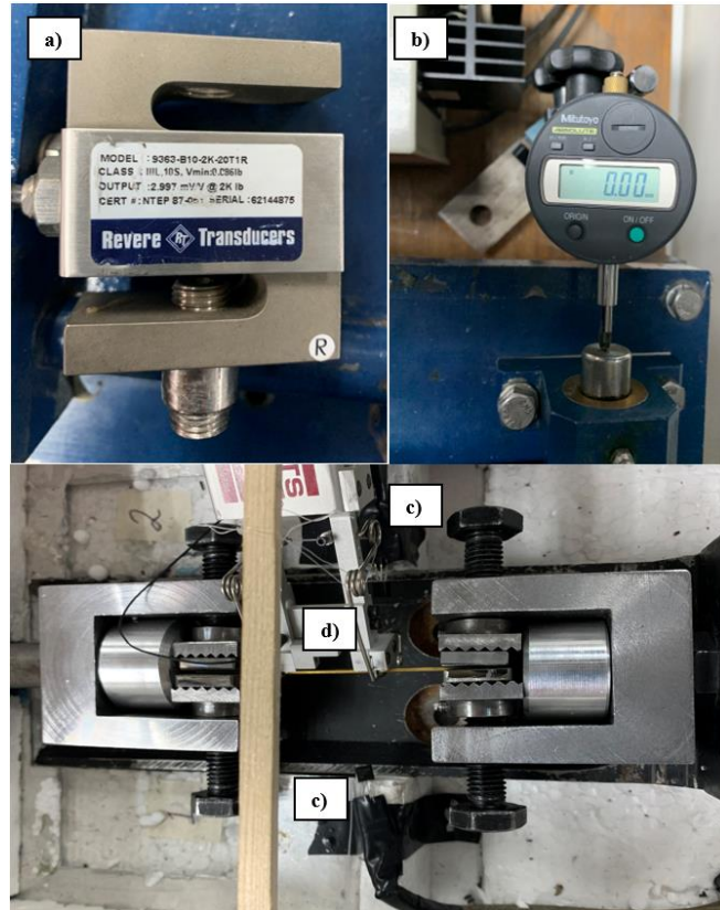
Figura 3-11. Instrumentación: a) Celda de carga b) Dial digital c) Termoresistores LM35DZ d) Extensómetro
