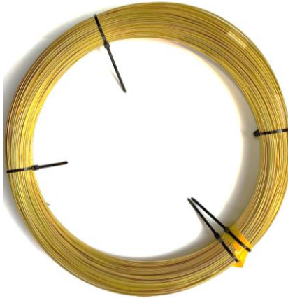
Figura 3-1. Alambre de 1.4mm de SMA de CuAlBe
