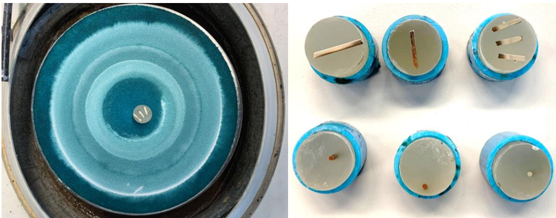
Figura 3-5. Muestras pulidas para el análisis metalográfico
