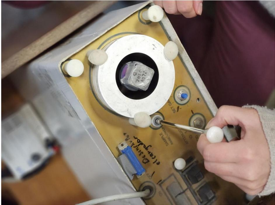
Figura 15: Medición de MRN en el magnetómetro de rotación Molspin.
