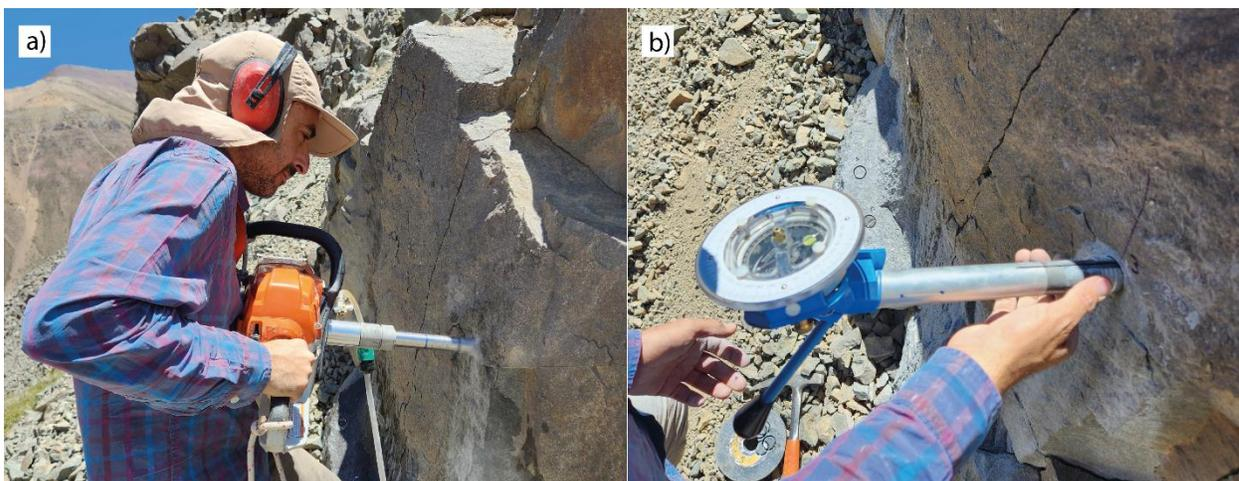
Figura 12: Muestra paleomagnética en terreno. a) Perforación de la roca; b) Orientación del testigo.
