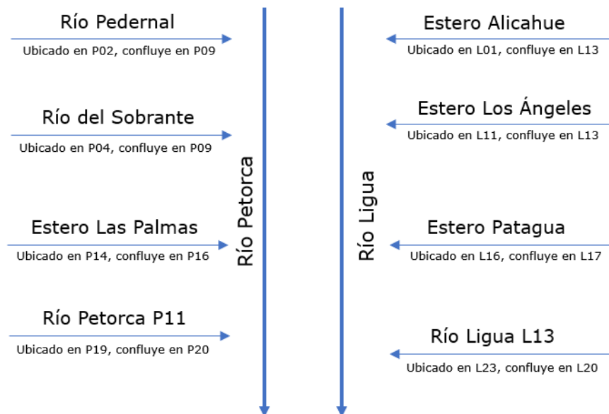
Figura 3.9: Diagrama de los elementos de río que se definen en el modelo hidrológico de las cuencas Ligua-Petorca. (Fuente: Elaboración propia )
