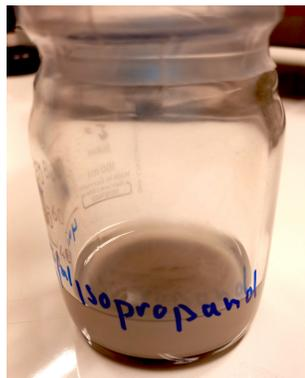
Figura 4.1: Solución de nano-diamantes pocos minutos tras finalizar los procesos de dispersión.
