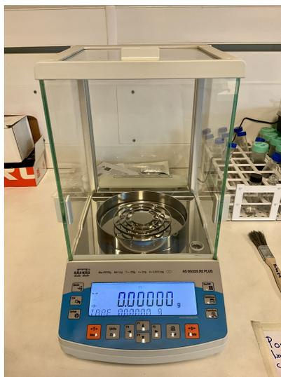
Figura 3.1: Balanza electrónica de alta precisión.
