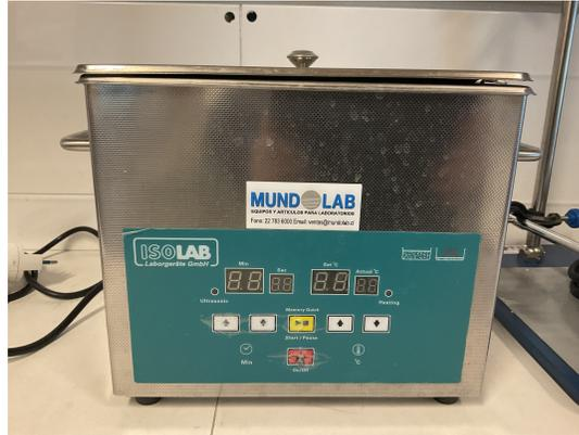
Figura 3.4: Equipo de baño de ultrasonido.
