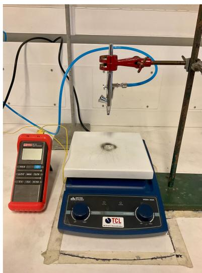
Figura 3.5: Arreglo del aerógrafo y la placa caliente para realizar el spray-coating.
