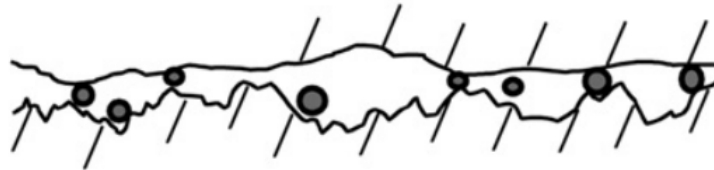
Figura A.5: Mecanismo de tercer cuerpo [14].
