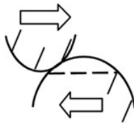
Figura A.2: Fricción por deformación de las asperezas entrelazadas [14].
