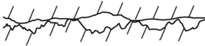
Figura A.1: Fricción adhesiva [14].
