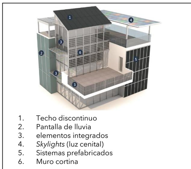
**Fig. 3:** Esquema de aplicaciones BIPV en edificaciones. Fuente: SUPSI, 2020.
