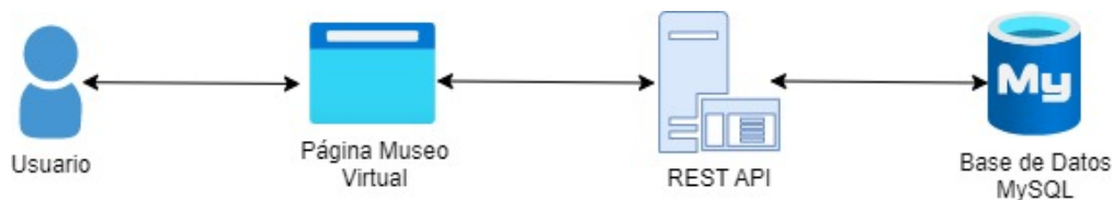
Figura 3.1: Diagrama de flujo que ilustra las interacciones y conexiones entre el usuario, la página web (museo virtual), la REST API y la base de datos.
