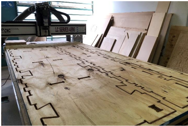
Fig 2: Router CNC, LC Series 4896 con placas ya cortadas Fuente: Elaboración Propia
