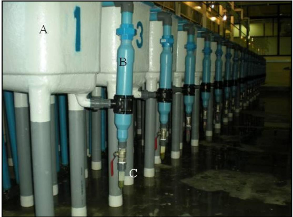
Figura 1. Sistemas de estanques utilizados en el ensayo de digestibilidad *in vivo*. En el detalle se observa estanque contenedor de peces (A), columna de decantación de PVC (B) y tubo centrifuga de 50 cc para colección de heces (C).
