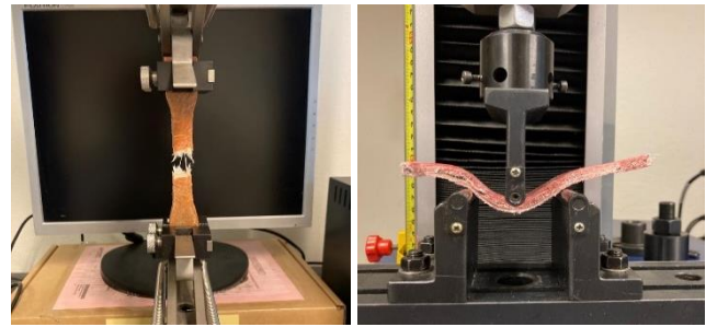
Imagen 3: máquinas de pruebas. La primera mide la tracción, la segunda la flexión. Fuente: elaboración propia.
