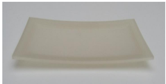
Fig. 19: Deformación en placa diamante de 1mm sometida a pruebas de resistencia. Fuente: Elaboración propia.
