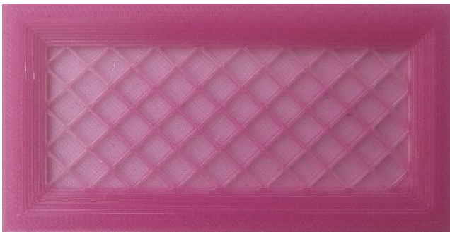
Fig. 21: Placa diamante de 3mm sometida a pruebas de resistencia que no sufrió ninguna deformación o fatiga. Fuente: Elaboración propia.
