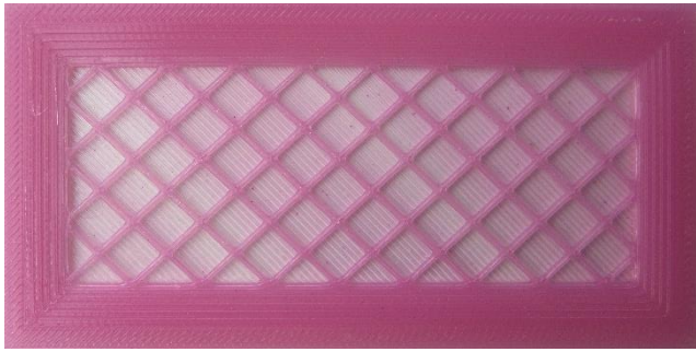
Fig. 20: "Pecas" de pigmentación en placa diamante de 2mm sometida a pruebas de resistencia. Fuente: Elaboración propia.
