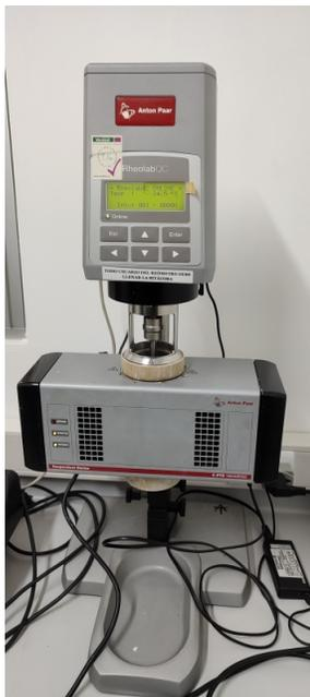
Figura 3.9: Reómetro comenzando la medición.
