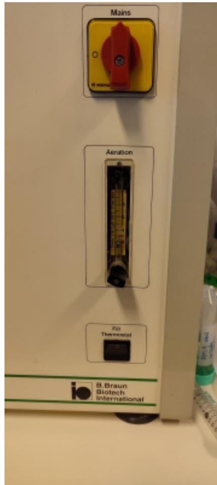
Figura 3.5: Aireación de un reactor con volumen de operación de 1L (1,5 vvm).
