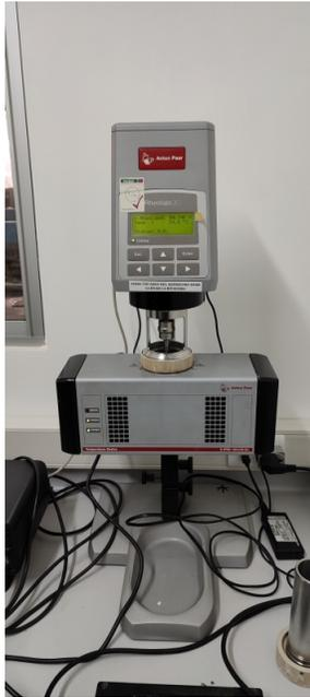
Figura 3.8: Reómetro en proceso de ajuste de temperatura.
