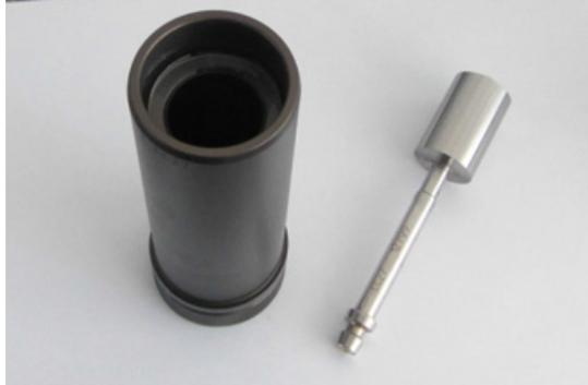
Figura 3.6: Cilindro concéntrico para medición.
