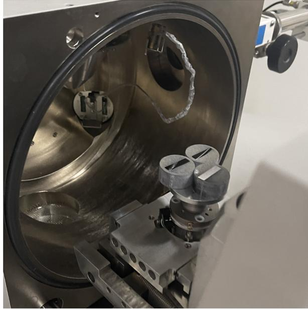
Figura 3.9: Muestra encapsulada ingresando a cámara de vacío.
