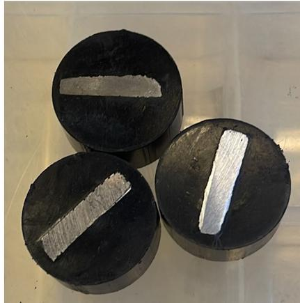
Figura 3.6: Muestras metalográficas encapsuladas.
