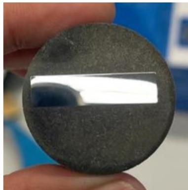
Figura 3.8: Muestra encapsulada pulido espejo.
