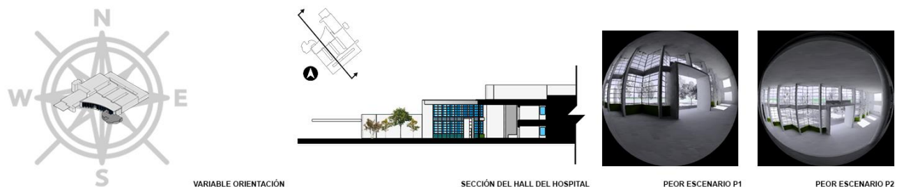
Fig. 3: Variable orientación, sección del abalconamiento y posicionamiento de cámaras para cálculo DGP. Fuente: Elaboración propia.
