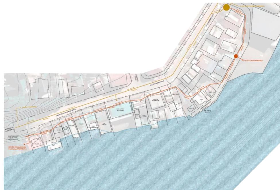
**Figura N°61:** Planta conjunto palafítico P.A.C-E.Lillo con propuesta esquemática de solución por incorporación de red paralela y planta reelevadora.
