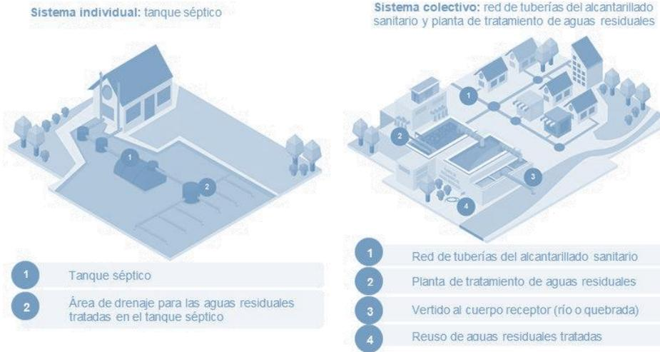
Figura N°4: Comparación sistema individual vs sistema colectivo.
