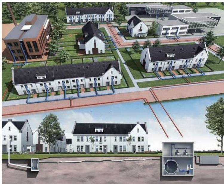
Figura N°47: Funcionamiento red por vacío en conjunto de viviendas.
