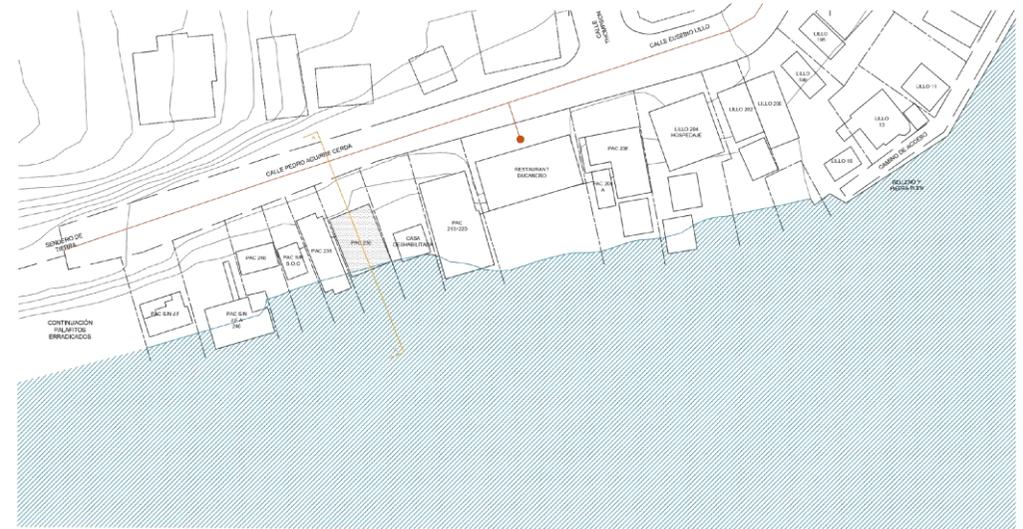
**Figura N°30:** Planta conjunto P.A.C -LILLO de edificaciones que están conectadas al sistema de alcantarillado según deducción a partir de análisis de construcciones bajo la cota de solera.
