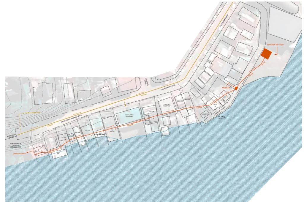
**Figura N°50:** Planta conjunto palafítico P.A.C-E.Lillo con propuesta esquemática de solución mediante red por vacío.
