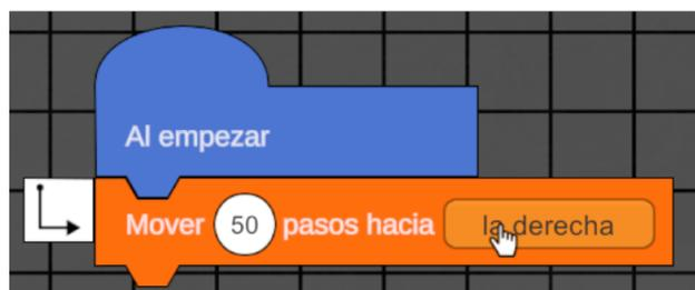
Figura 3.5: Bloque Inicial enlazado con uno de Movimiento.
